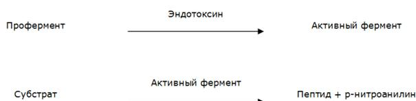
Система Endosafe-PTS, включающая cartridge и прибор, использует принцип определения эндотоксина, который применяется в хромогенном кинетическом анализе и хромогенном анализе по конечной точке. В этих методах измеряется интенсивность окраски реакционной смеси, которая находится в прямой зависимости от концентрации эндотоксина в образце. Каждый cartridge содержит точные количества лицензированных FDA ЛАЛ-реактива, хромогенного субстрата и Контрольного стандарта эндотоксина (КСЭ).
